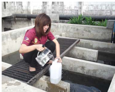
เก็บตัวอย่างน้ำทิ้งที่ระบบบำบัดน้ำเสีย
